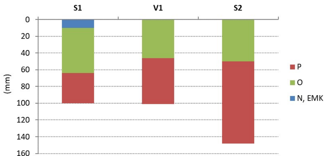
Obrázek 2 Tloušťky asfaltem stmelených konstrukčních vrstev, místní komunikace Hlavní
